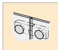
A zsanérok a kabin belső részén az üveggel egy síkban vannak
